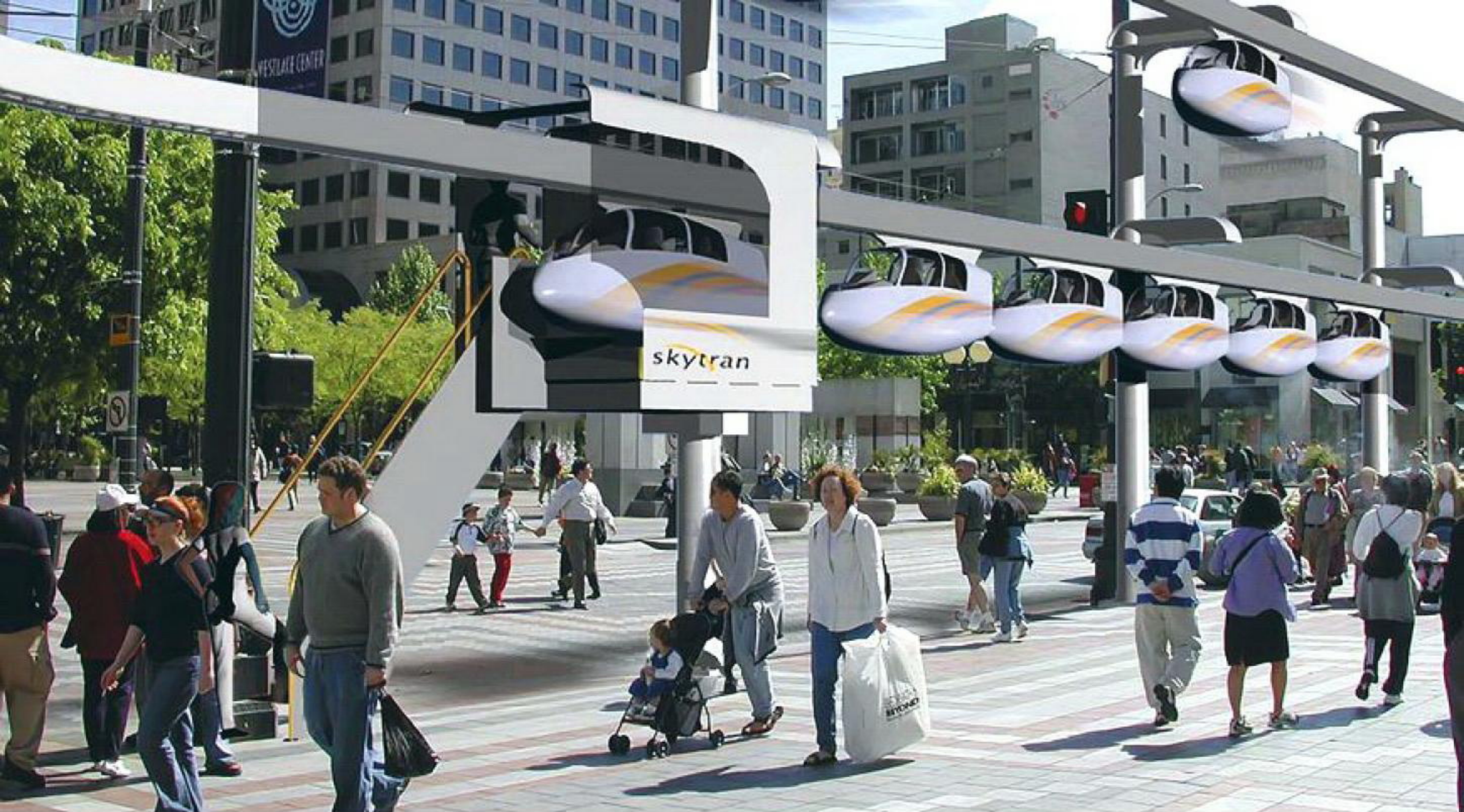
▲ Индивидуальная система скоростного транспорта SkyTran: скорость подвесных пассажирских магнитопланов достигает 240 км/ч
